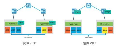
除了使用 VXLAN/NVGRE/GENEVE 的虚拟化环境外,通常还有裸机服务器 (BMS) 或传统网络,它们只能使用 VLAN,或发往 VPN 网络或互联网的南北向流量。在这些情况下,使用软件 VTEP 网关会增加额外跳转,还可能造成性能瓶颈,而最佳做法是使用 BMS 所连接的 ToR 作为硬件 VTEP。
