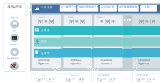
统，从而带来史无前例的操作简单性、可伸缩性和时间效率：此“单机架数据中心”解决方案按照 BYOH 硬件原则进行构建，将它应用于一组特定的计算、存储和网络组件，选择这些组件是为了在单个 42RU 数据中心机架中实现最大云计算能力。
